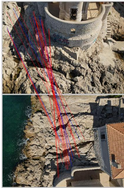
Figure 5 : Tie Points entre deux photos (bleu retenus, rouges non retenus)
