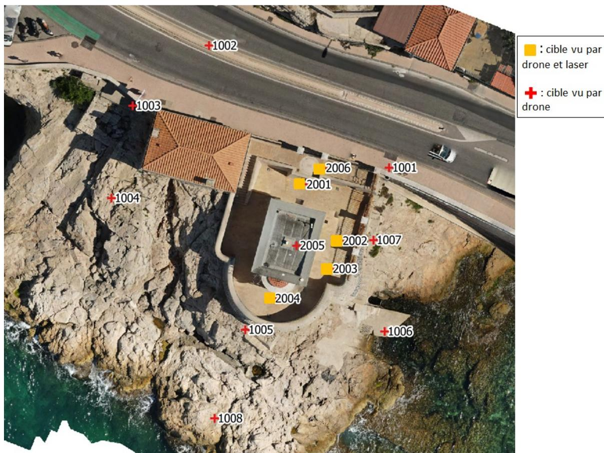
*Figure 1 : Schéma de l'emplacement des cibles photogrammétriques sur le site du marégraphe*
